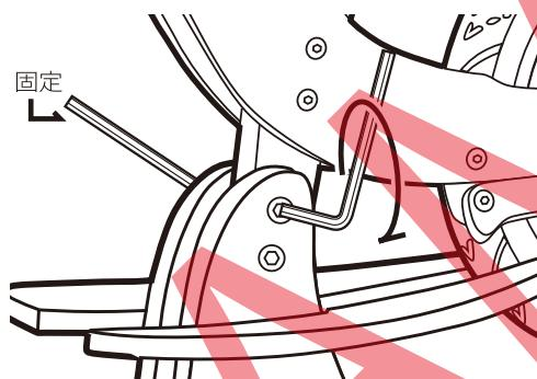
E 下側が止まれば最後に先ほど緩めたシート側のボルトを締め直してください。
