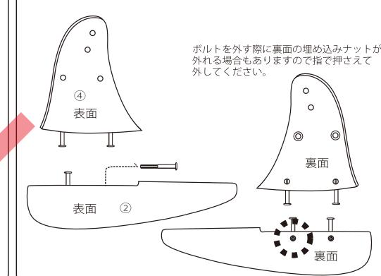
**C** 外したボルトを下図のように④の裏面からボルトを通して埋め込みナットが落ちないように②の足置き部品を固定してください。(左足置き箇所が完成したら右同じように固定してください。)
