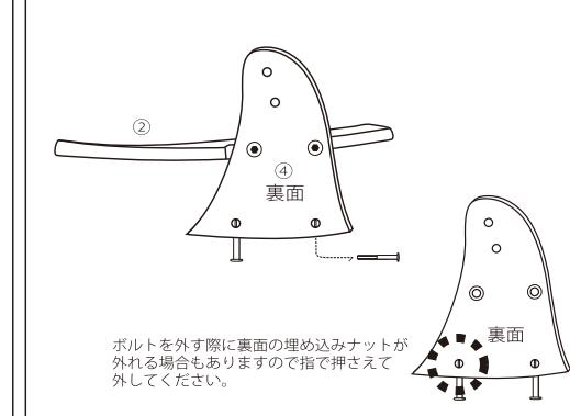
**E** ①のボードの裏面から先程外したボルトを通して④の足置き箇所を固定してください。
